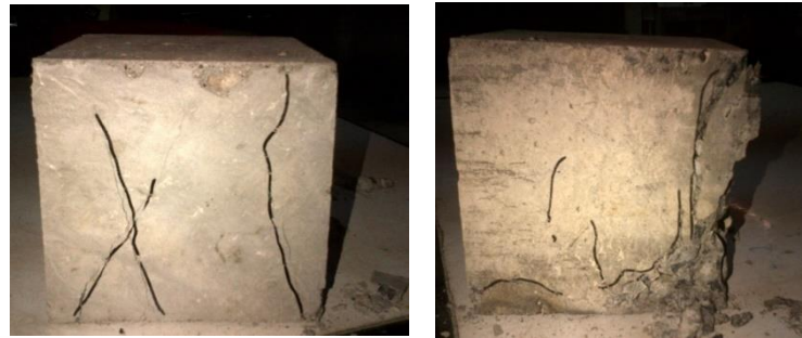
Gambar 4.19 Hasil Pola Retak Pengujian Kuat Tekan dengan Sampel Pasir Cepu dicuci dengan Admixture 100% Pada Umur 14 Hari
