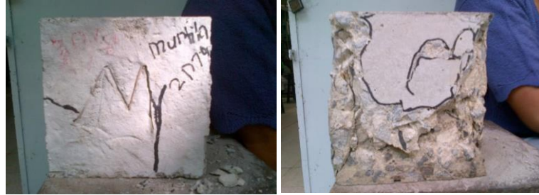
Gambar 4.7 Hasil Pola Retak Pengujian Kuat Tekan dengan Sampel Pasir Muntilan Tanpa Cuci dengan Admixture 0% Pada Umur 14 Hari
