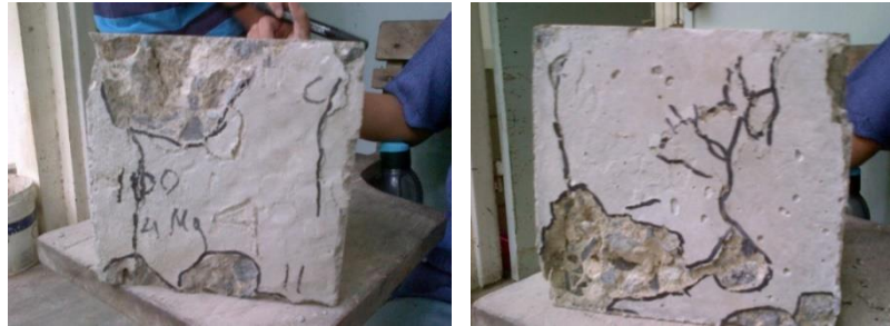
Gambar 4.43 Hasil Pola Retak Pengujian Kuat Tekan dengan Sampel Pasir Cepu Tanpa Cuci dengan Admixture 100% Pada Umur 28 Hari
