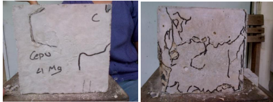
Gambar 4.31 Hasil Pola Retak Pengujian Kuat Tekan dengan Sampel Pasir Cepu Tanpa Cuci dengan Admixture 0% Pada Umur 28 Hari
