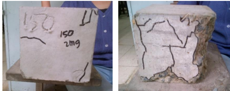
Gambar 4.25 Hasil Pola Retak Pengujian Kuat Tekan dengan Sampel Pasir Cepu Tanpa Cuci dengan Admixture 150% Pada Umur 14 Hari
