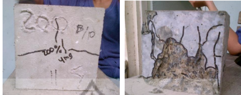
Gambar 4.49 Hasil Pola Retak Pengujian Kuat Tekan dengan Sampel Pasir Cepu Tanpa Cuci admixture 200% Pada Umur 28 Hari
