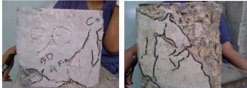
Gambar 4.37 Hasil Pola Retak Pengujian Kuat Tekan dengan Sampel Pasir Cepu Tanpa Cuci dengan Admixture 50% Pada Umur 28 Hari
