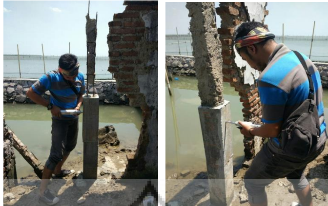
Gambar 4.2 Hammer Test bulan ke-13 Desa Sriwulan, Kec. Sayung
