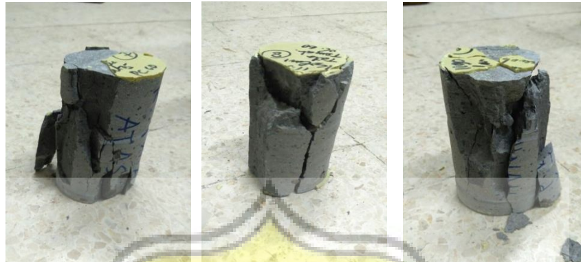
Gambar 4.19 Silinder Beton Kolom 1 Zona Atas (1), Zona Tengah (2), dan Zona Bawah (3) di Pucang Gading
