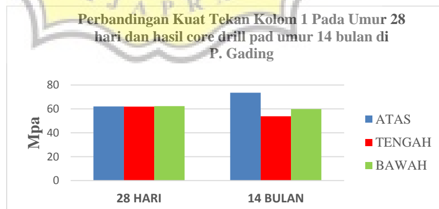
Gambar 4.30 Perbandingan Rerata Kuat Tekan (MPa) Kolom 1 Pada Umur 28 Hari dan Hasil Core Drill Pada Umur 14 Bulan di Pucang Gading
