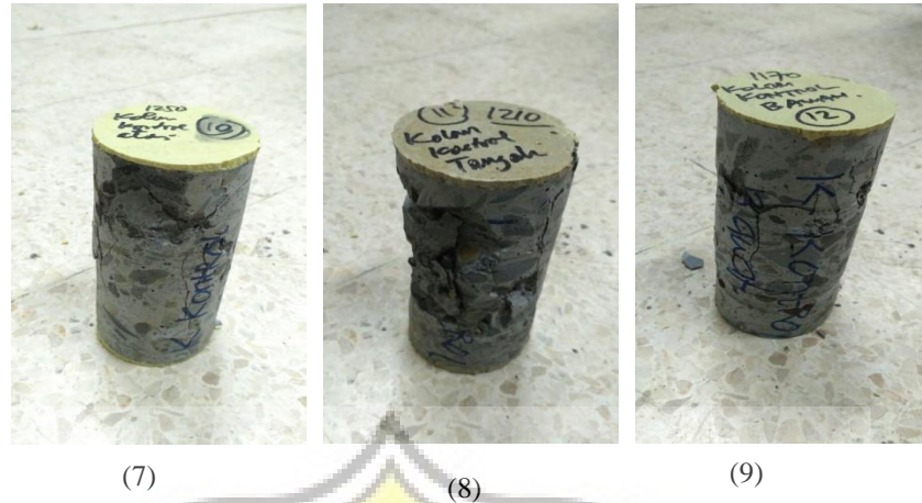
Gambar 4.18 Silinder Beton Kolom Kontrol Zona Atas (7), Zona Tengah (8),
