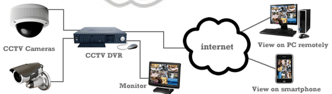
Diagram 3 14 Pola kerja kamera cctv Sumber: axis.com
