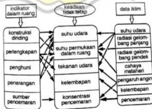
Gambar.5. 15 Diagram Keseimbangan termal dalam bangunan
