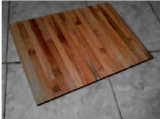
Gambar 5. 12 Material penutup lantai bambu laminasi
