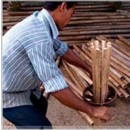
Gambar 3. 22 proses pembelahan batang bambu menggunakan Hand Spilting
