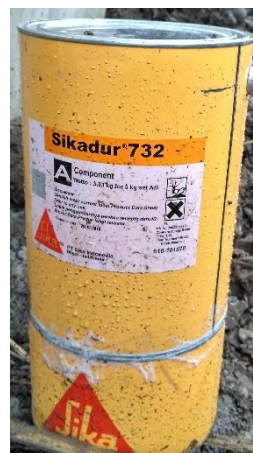
Gambar 3. 20. Sika yang Digunakan Untuk Menghaluskan Sambungan Antar Girder
