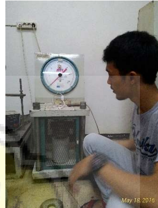
Pengujian Menggunakan Alat Compression Test Machine
