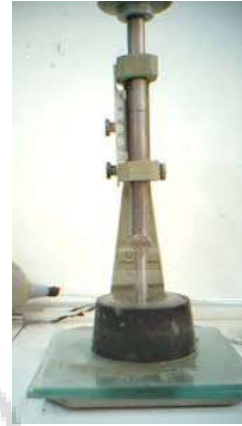
Pengujian Pengikatan Awal Semen (Jarum Vicat 10 mm)
