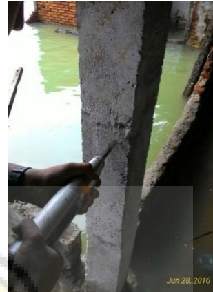
Pengujian dengan alat Hammer Test
