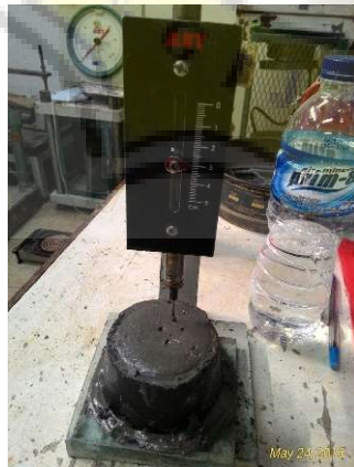
Pengujian Pengikatan Awal Semen (jarum vicat 1 mm)
