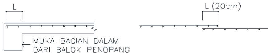
Gambar 4.3 Panjang Penyaluran dan Lewatan
